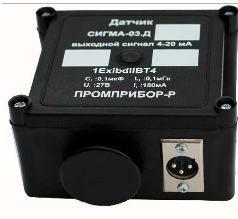
Рис.2. Внешний вид датчика, 1- защитная крышка сенсора, 2-розетка.
